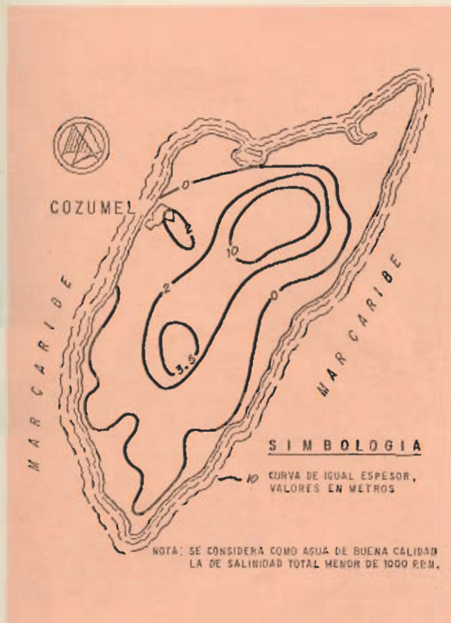
Figura 14. Espesor saturado con agua de buena calidad.
